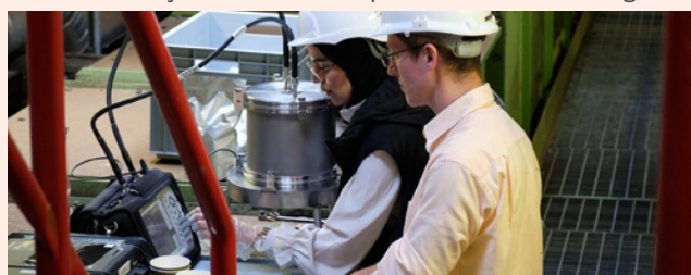
Campagne d'étalonnage in situ, coordonnée par le Danish Technological Institute (Danemark), au sein de la société Verdo. (site de Randers - Danemark). Utilisation de la cavité résonante
