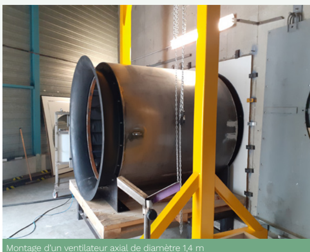
Montage d'un ventilateur axial de diamètre 1,4 m
