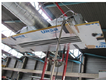
Figure 11 - Diffuseur linéaire monté sur un plafond (seul, à gauche - entouré par un cadre de déport, à droite)
