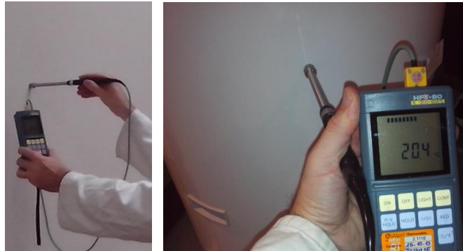
Figure 8 : Mesure de la température d'un mur et d'une paroi d'un ballon d'eau chaude
