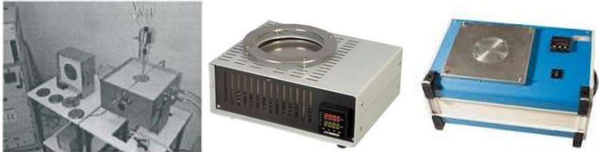
Figure 27 : Générateurs de température de surface (LNE, Omega, Pyro-contrôle)
