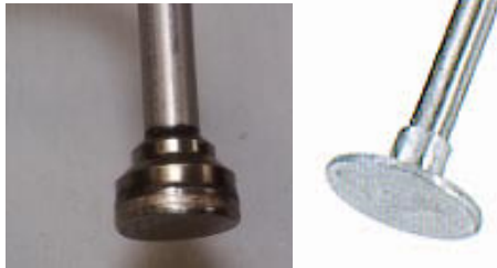
Figure 37 : Photos de capteurs type I (avec ajout d'une semelle conductrice)
