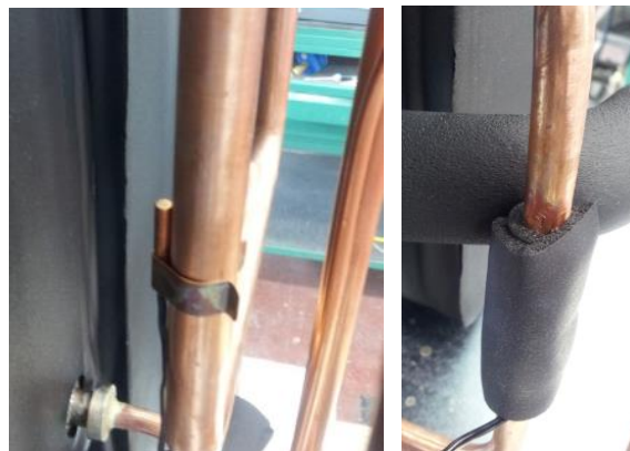
Installation de capteurs sur une conduite (fixation et isolation thermique)
