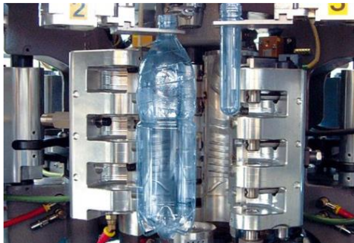
Figure 6: Photo d'un moule de bouteille plastique
