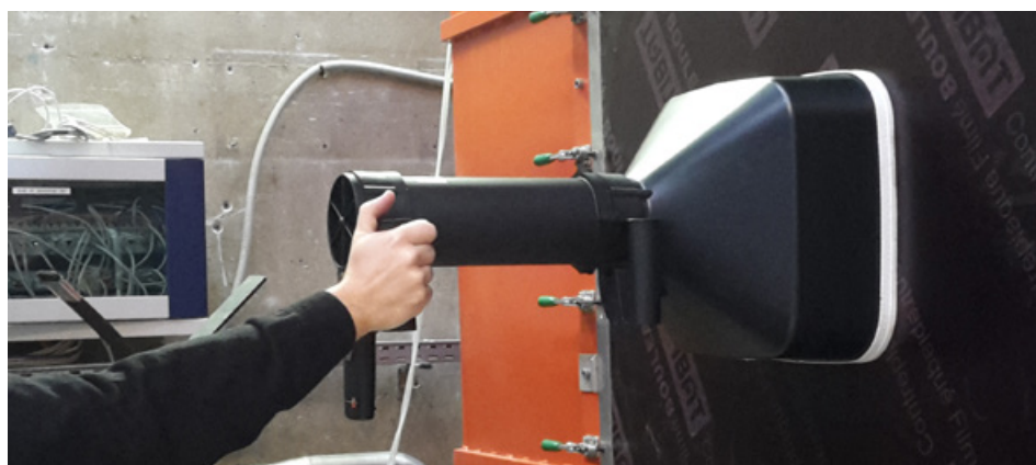
Figure 7 Exemple d'un cône de mesure avec moulinet et prolongateur
