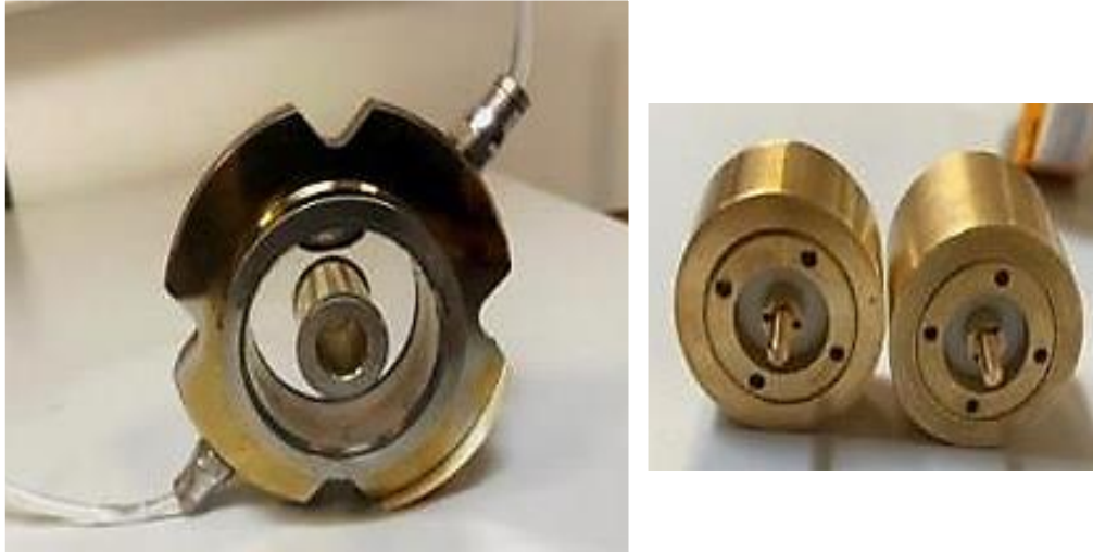
Figure 51 : photo des portes-échantillons liquide de : (gauche) la cellule coaxiale LNE-CETIAT . (droite) la cellule EpsiMu ®.
