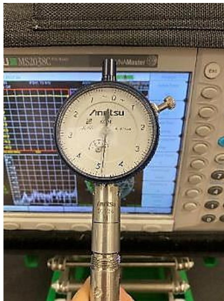
Figure 39 : photo de la jauge de profondeur connectée au connecteur du câble coaxial.
