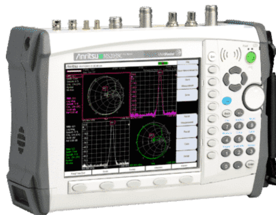
Figure 20 : photo de l'analyseur de réseau vectoriel utilisé MS2038C - fourni par Anritsu .
