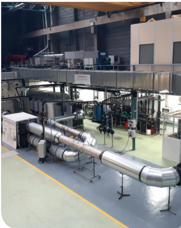
Cette nouvelle plateforme a pour fonction de tester les centrales de traitement d'air, les systèmes de récupération de chaleur et les échangeurs de chaleur. Les essais sur la plateforme CTA permettent de déterminer les performances aérodynamiques, thermiques, acoustiques et/ou mécaniques des équipements testés.
