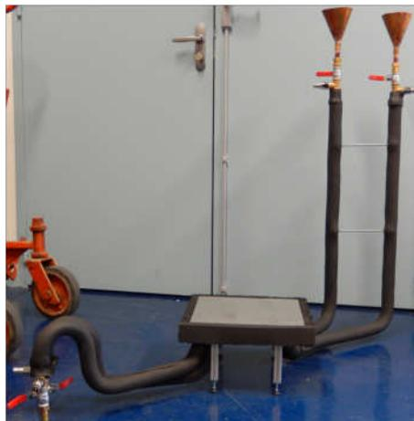
FIGURE 4.12 – Dispositif réalisé pour le circuit d'eau glycolée gravitaire
