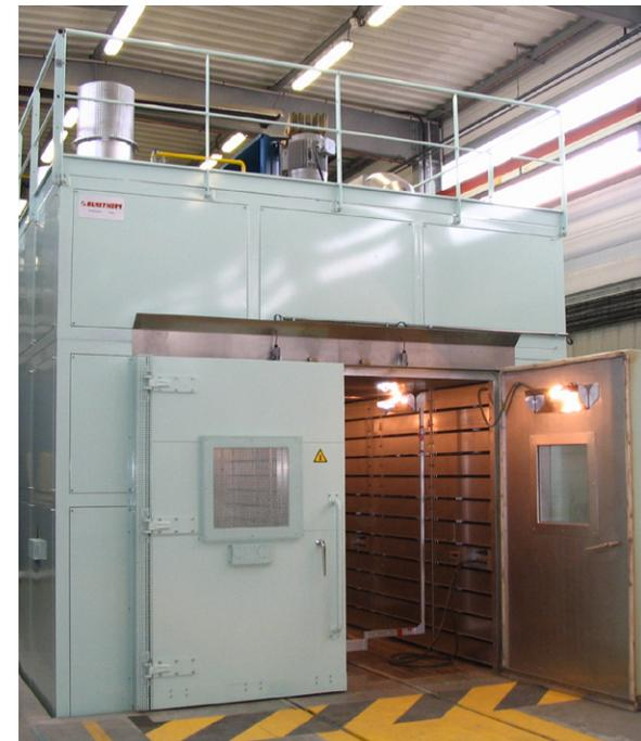
Exemple de sécheur étuve à double battant - © ELMETHERM
