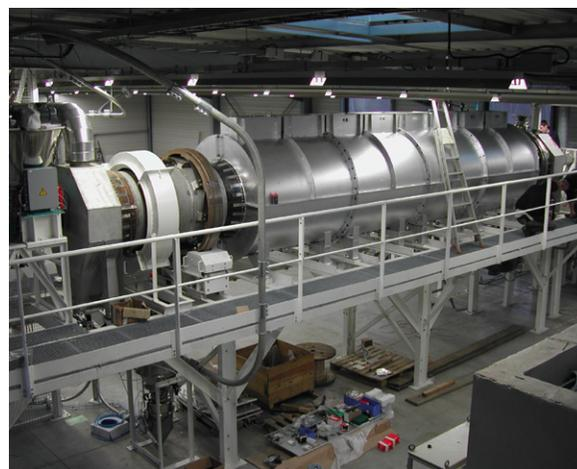
Exemple de tambour rotatif (chauffé par la paroi)
