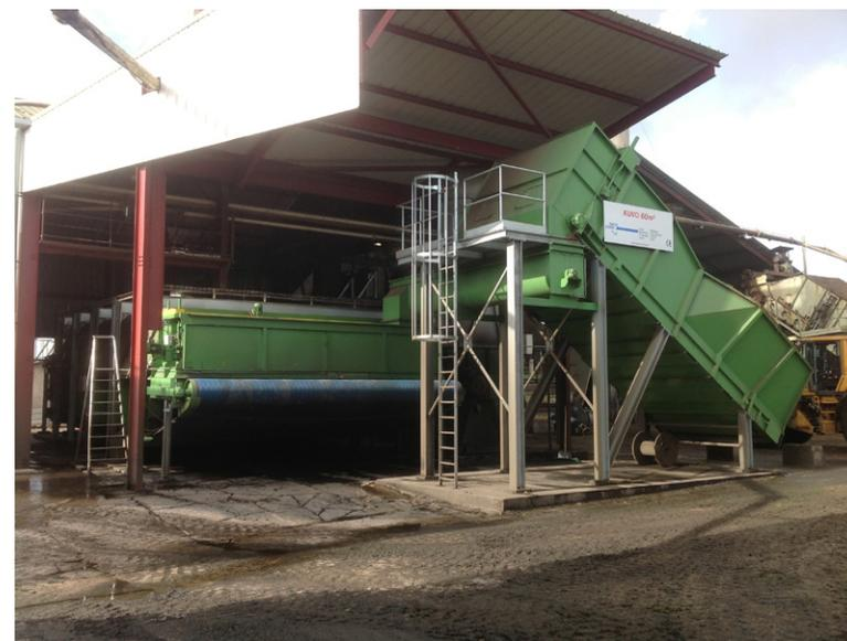
Vue pré-séchoir avec caisson d'alimentation en produit
