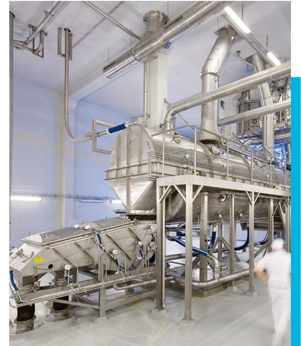
Exemple de sécheur par lit fluidisé - © GEA, GEA dryer
