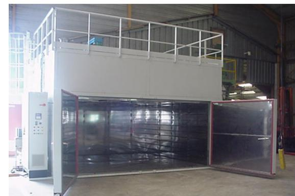
Exemple de sécheur étuve - © ELMETHERM
