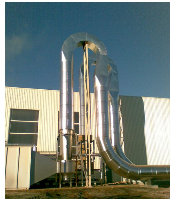
Exemple de sécheur flash - © COMESSA
