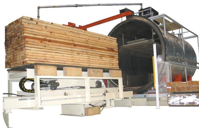
Bilan pour le séchage de bois de résineux d'épaisseur 140 mm avec une humidité initiale de 45% et une humidité finale de 19%
