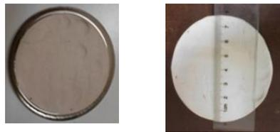
Figure 102 : Échantillon kaolinite adapté à la cellule capacitive: humide à gauche et sec à droite
