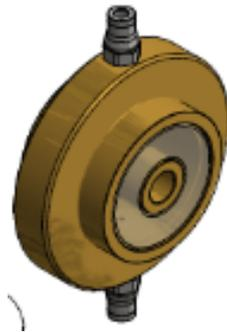
Figure 88 : Porte échantillon liquide
