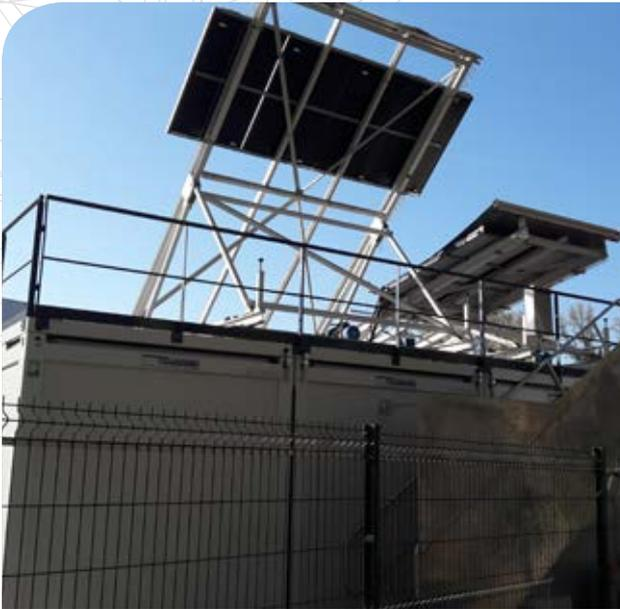
2017 a également vu le transfert de Nîmes à Villeurbanne de la plateforme Bélénos permettant ainsi d'assurer une continuité de services et la poursuite des programmes en cours dans le domaine du solaire. La plateforme est destinée aux essais de chauffe-eau solaires individuels et de capteurs solaires dans un cadre normatif, mais ses moyens lui permettent aussi de proposer des prestations d'aide au développement de produits ou d'études générales, en solaire thermique.
